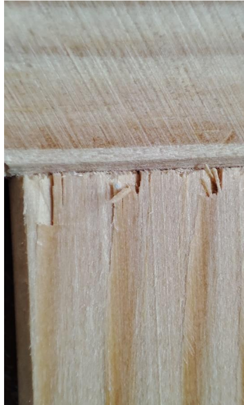
Detalle defectos bastidor.
